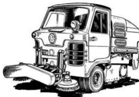
Рис. 3. Тротуароуборочная машина ТУМ-975 [1]
