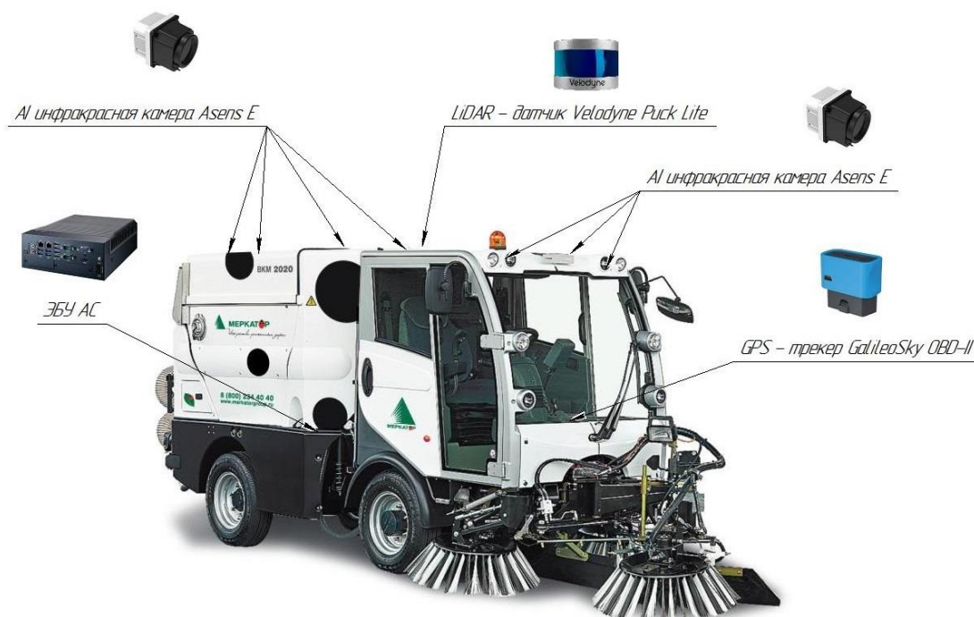
Рис. 5 Схема расположения оборудования на автомобиле ВКМ 2020 при первом варианте
