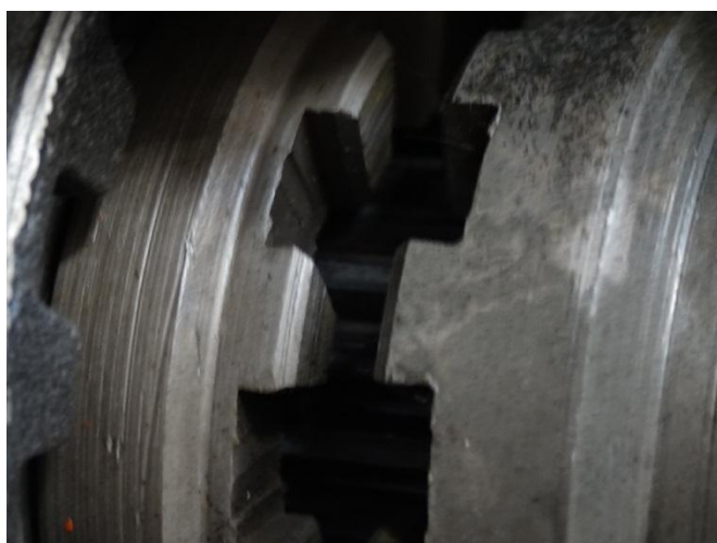
Рис. 2. Зубчатая муфта механизма блокировки межколёсного дифференциала автомобиля КАМАЗ
