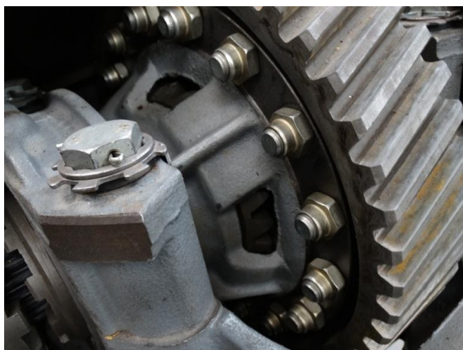
Рис. 1. Межколёсный дифференциал автомобиля КАМАЗ
