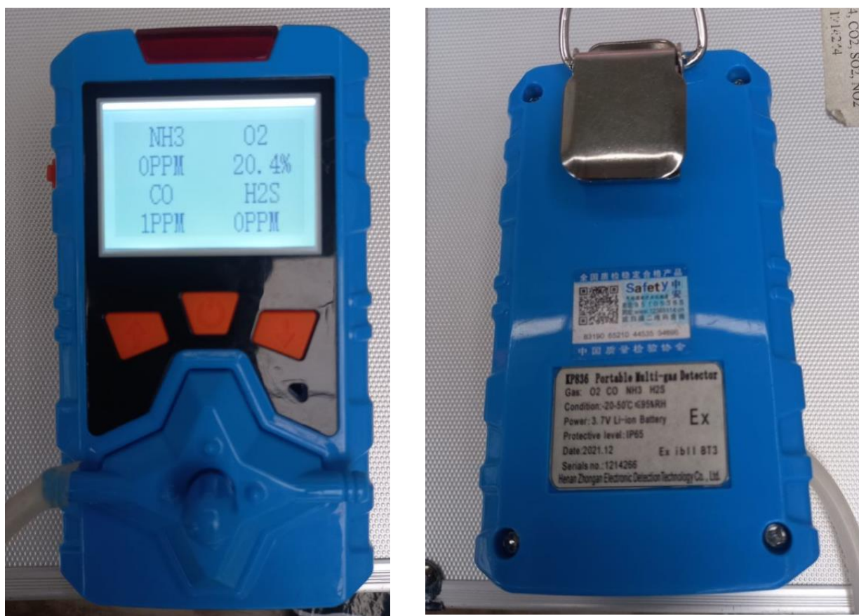
Рис. 2. Газоанализатор Portable multi-gas Detector KR-836
