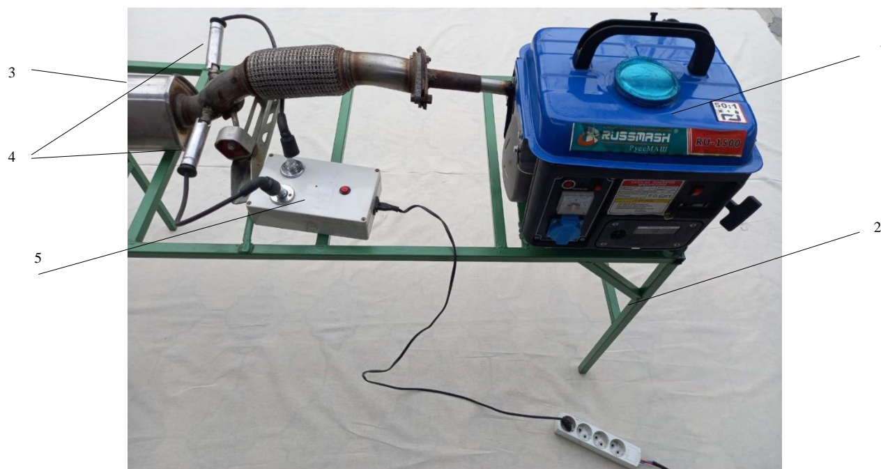
Рис. 1. Лабораторная установка: 1- генератор с двигателем Gasoline 1200; 2- рама; 3-глушитель автомобиля "Оникс"; 4- свечи зажигания; 5-искрообразователь.
